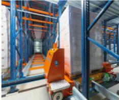
IN COMBINATION WITH STACKER CRANES, THE PALLET SHUTTLE SYSTEM CAN REACH A STORAGE HEIGHT OF UP TO 40 M.
